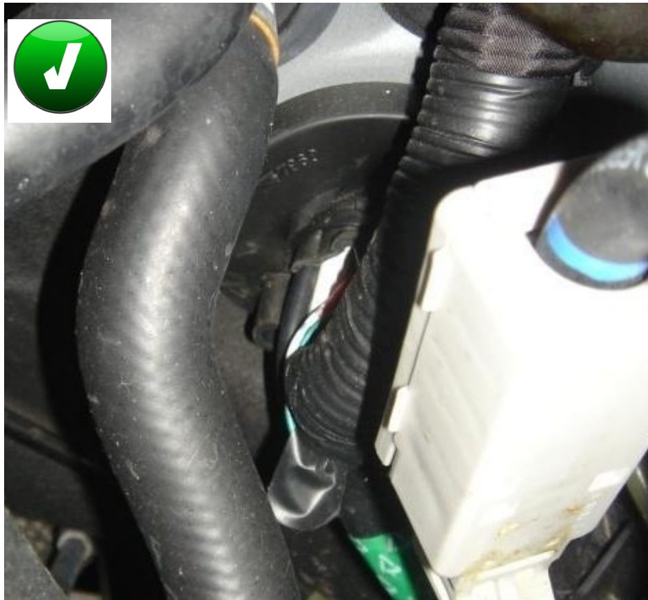
Рисунок 128. Проложенный через штатное отверстие жгут
