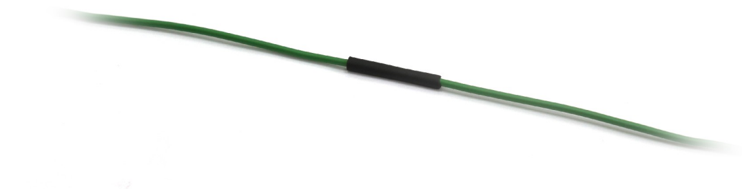
Рисунок 154. Термоусадочная трубка на пайке
