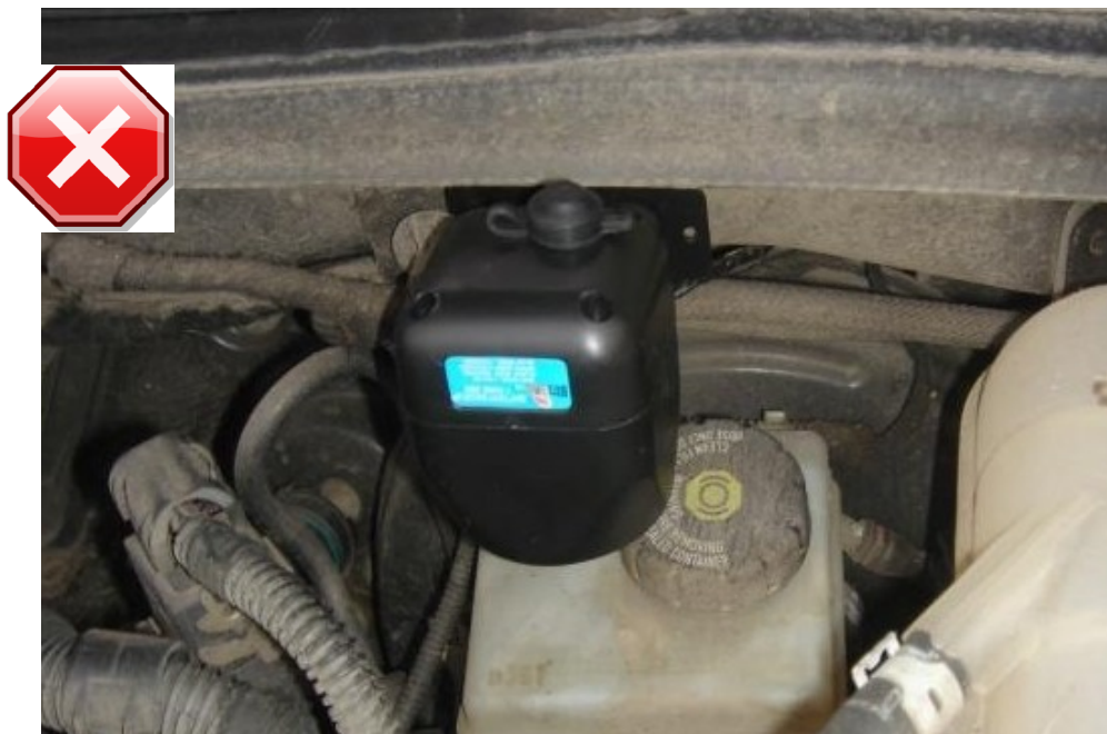
Рисунок 135. Сирена, перекрывающая крышку бачка
