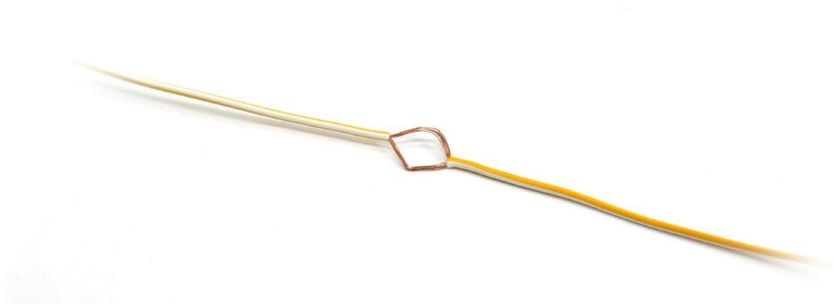
Рисунок 143. Оголение первого провода
